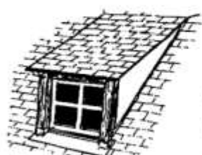
lucarne rampante ou en "chien couché"
